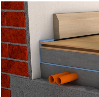
Exemple de mise en œuvre d'un revêtement de sol dur avec plinthe
