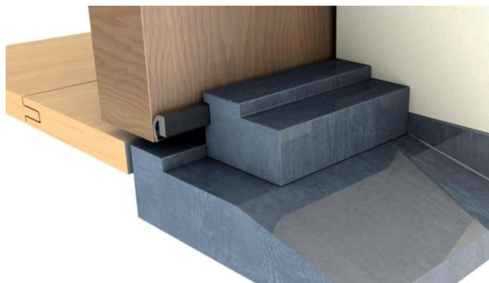
Exemple d'un revêtement de sol dur interrompu au droit du seuil (pour un seuil battée)
